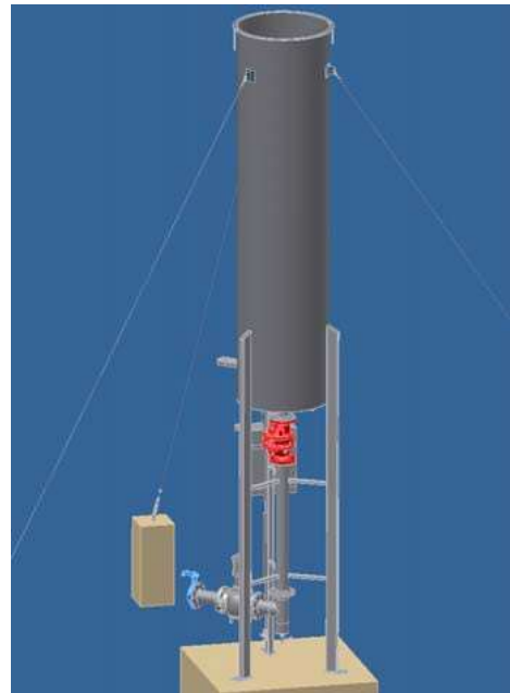
Abb 3 Vue d'ensemble de la base de la torche, de la tuyauterie et de la chambre de combustion
